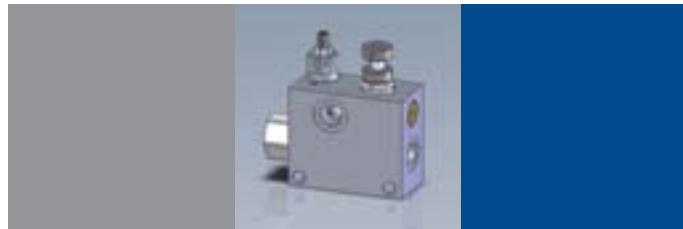
Servono a regolare la portata (funzione del regime di rotazione della pompa) di un circuito che risulta essere in eccesso rispetto alle esigenze dell'impianto. Le valvole sono compensate alla pressione di lavoro, pertanto la portata può essere regolata ad un valore registrabile e costante indipendentemente dalla pressione di lavoro. Nel verso opposto il regolatore perde la sua insensibilità alla pressione e si comporta come un semplice strozzatore.
